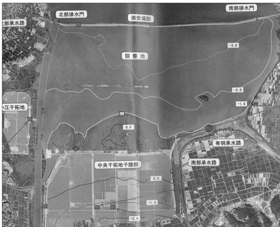
図14 調整池内底面標高図 平成14年7月農水省説明資料「諫早湾干拓事業について」から転載
